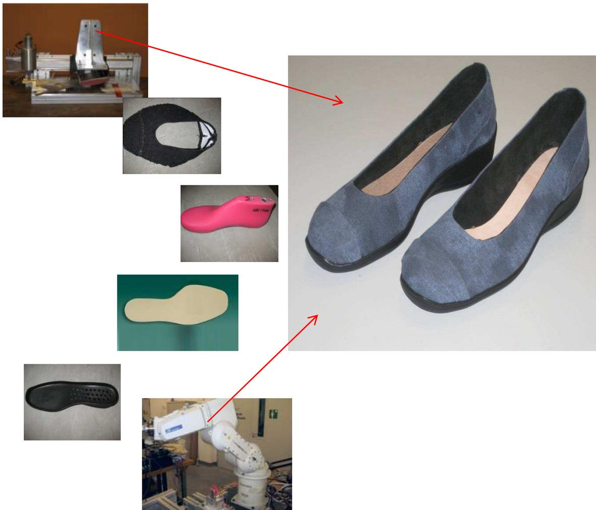
Die in diesem Projekt entwickelten Klebstoff-Auftragstechniken ermöglichen es, Schuhteile (wie Schafteile oder Schalensohlen) an den entsprechenden Stellen mit Klebstoff zu beschichten und zu verkleben.
