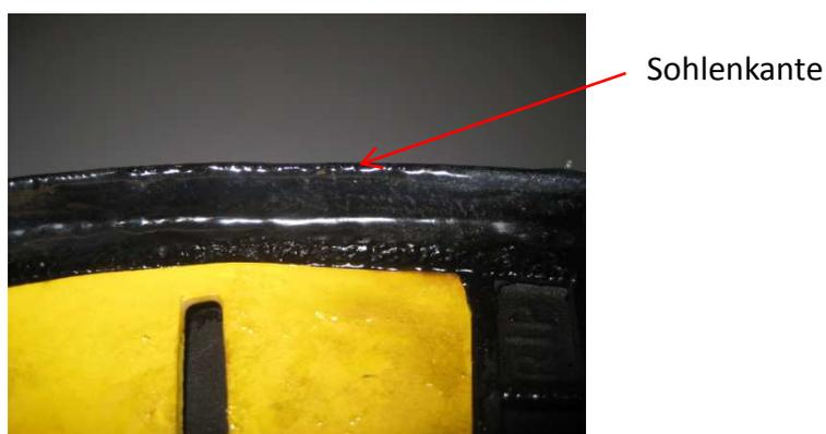
Durch das Aufrollen des Klebstoffes an der Innenseite der Schalensohle endet der Klebstoffauftrag exakt an der Sohlenkante. Die Schalensohle wird konturgenau bis zur Sohlenkante mit Klebstoff beschichtet.
