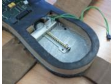
Abbildung 12: In die Sohle eingebauter Spindelmotor mit Klemmblock
