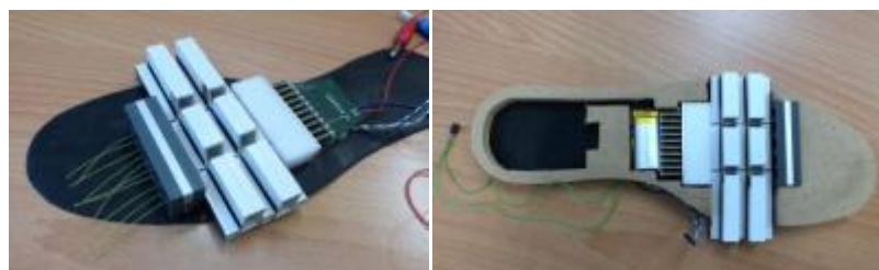
Abbildung 11: Aufbau einer Sohle mit Biegesteifigkeitseinstellung
