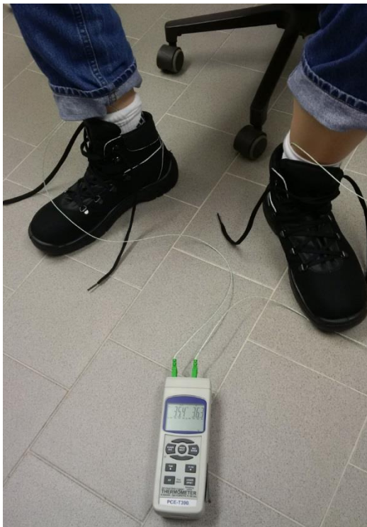
Bild 6: Trageversuche PFI mit Temperaturmessung im Schuh
