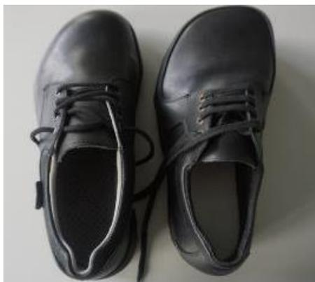
Abbildung 19: Vergleich der Testschuhe mit idealisierter Kappe (rechts) und angepasster Kappe (links).
