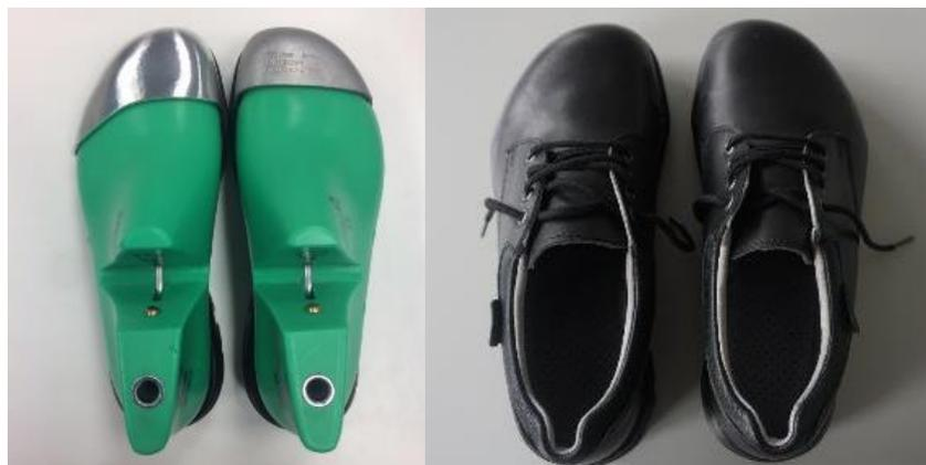
**Abbildung 16: Vergleich der Zehenschutzkappen. Links: neue ergonomische Kappe. Rechts: alte Kappenform.**
