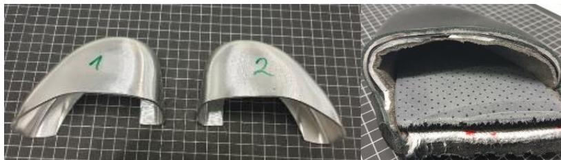
**Abbildung 18: links: Zehenschutzkappen nach Druckprüfung; rechts: Verbaute Zehenschutzkappe nach Druckprüfung.**
