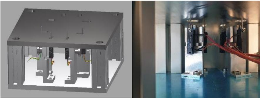
Abbildung 5: links: CAD-Konstruktion der Haltevorrichtung von oben; rechts: Ansicht von unten.
