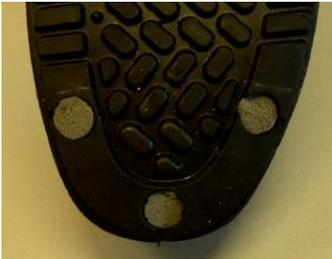
Abbildung 4: Anbringen des Messsystems im Schuh.
