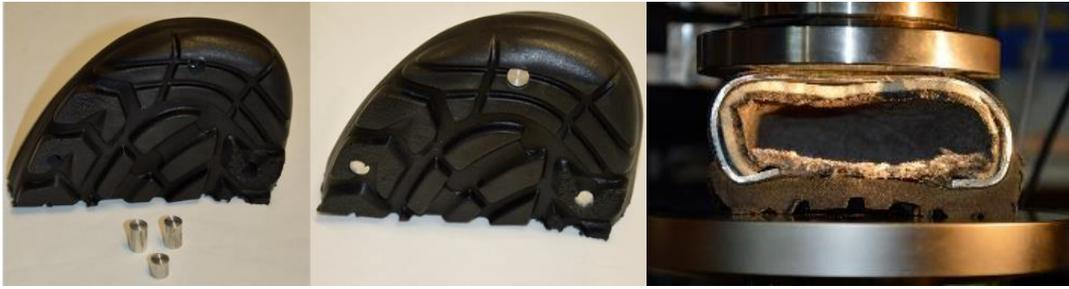
**Abbildung 17: links: Zehenschutzkappe mit Metallstiften zur Unterbauverstärkung; rechts: Zehenschutzkappe mit verstärktem Unterbau.**
