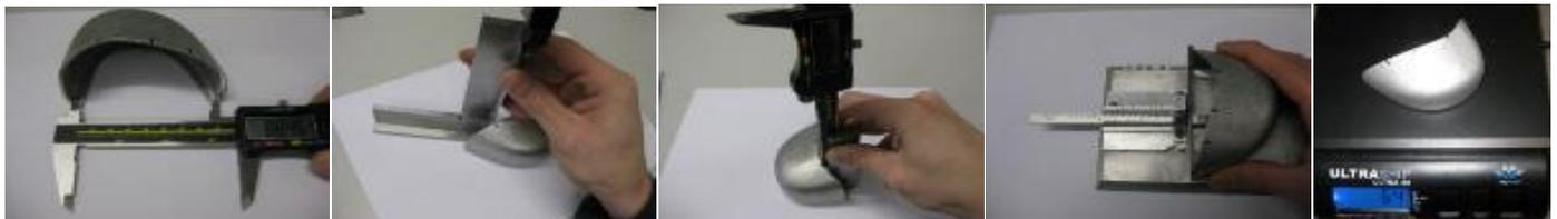
Abbildung 2: Manuelle Vermessung der Zehenschutzkappen. Die erhobenen Parameter sind
