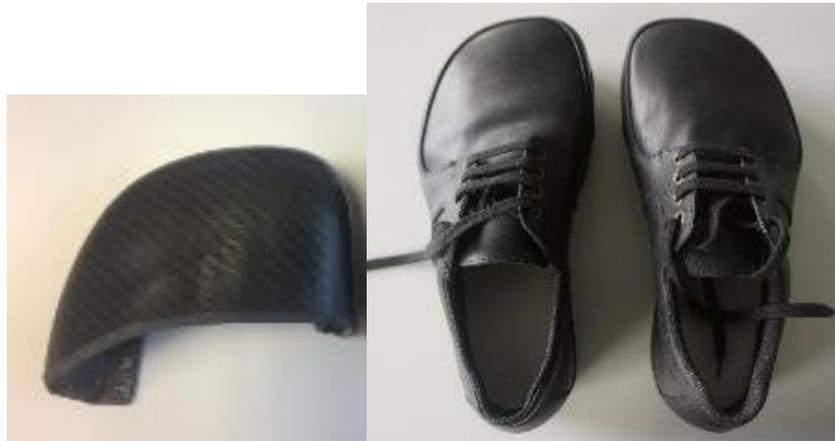
**Abbildung 14: links: Modell 1 (idealisierte Karbonkappen); rechts: fertiger Testschuh.**
