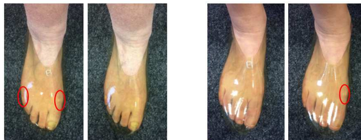
Abbildung 13: Beispiel Vergleich zwischen balligen (B) und planen (P) Schaft.
