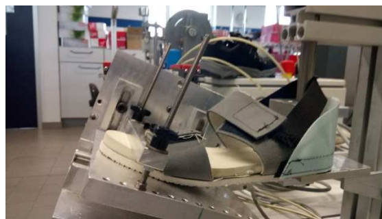
Abbildung 10: Gerät zur Bestimmung der Längssteifigkeit von Sohlen (Damensandale)
