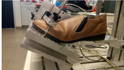
Abbildung 17: Beispiel Biegeprüfung Damenslipper (jeweils plan und ballig)
