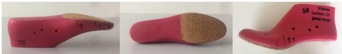
Abbildung 12: manueller Volumenaufbau am planen Leisten mit zur Spitze (zehenwärts) und zum Mittelfuß hinauslaufende Korkschicht
